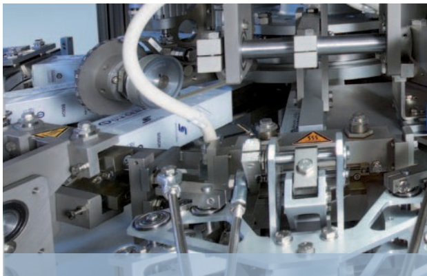
Modelagem precisa do saco por meio de uma roda de mandril
