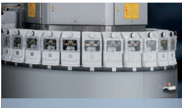
Alto vácuo da bolsa devido à roda de vácuo com 28 câmaras
